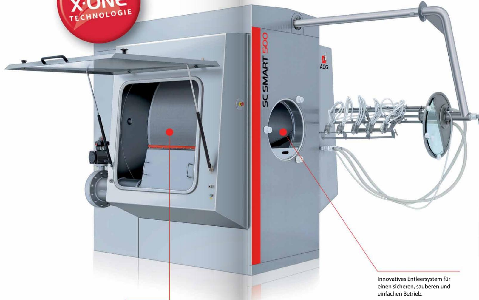
Komplett perforierte Trommel für eine optimale Luftströmung.
